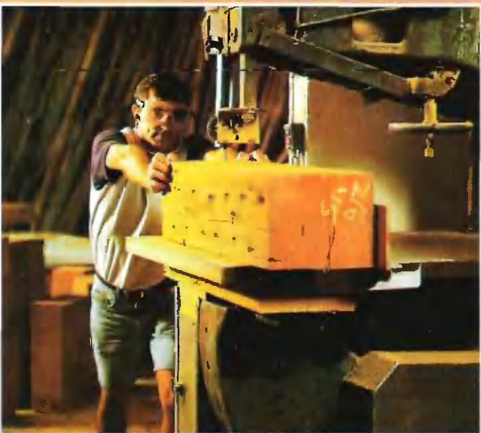
Старая сосновая балка распиливается на ленточной пиле мощностью 7,5 лошадиных сил с полотном шириной 4 см.
