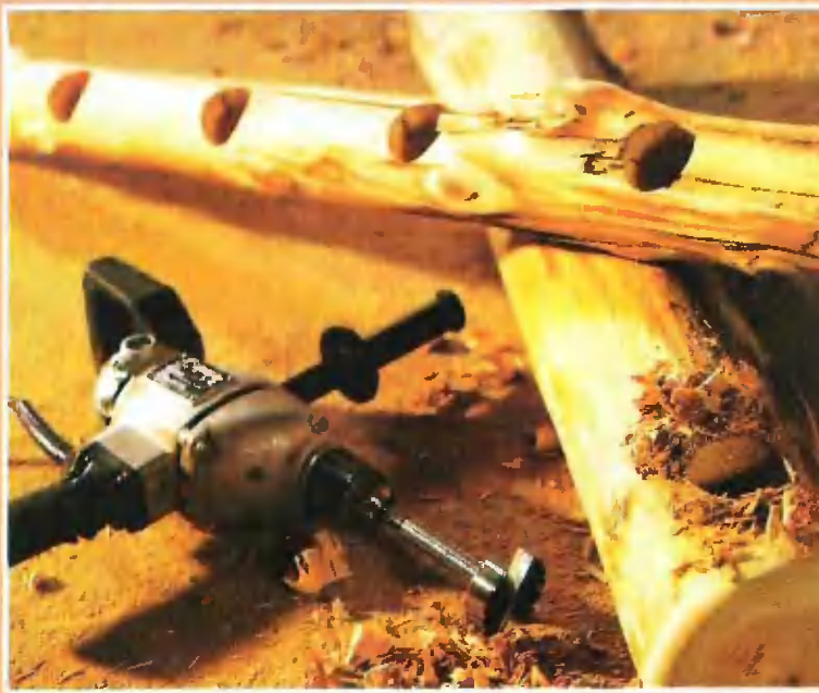
Выборка гнезд: сверлом Форстнера делают отверстия с плоским дном.
