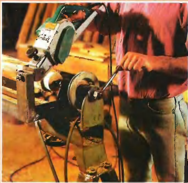
Резка шипов электрорубанком, закрепленным на петле.
